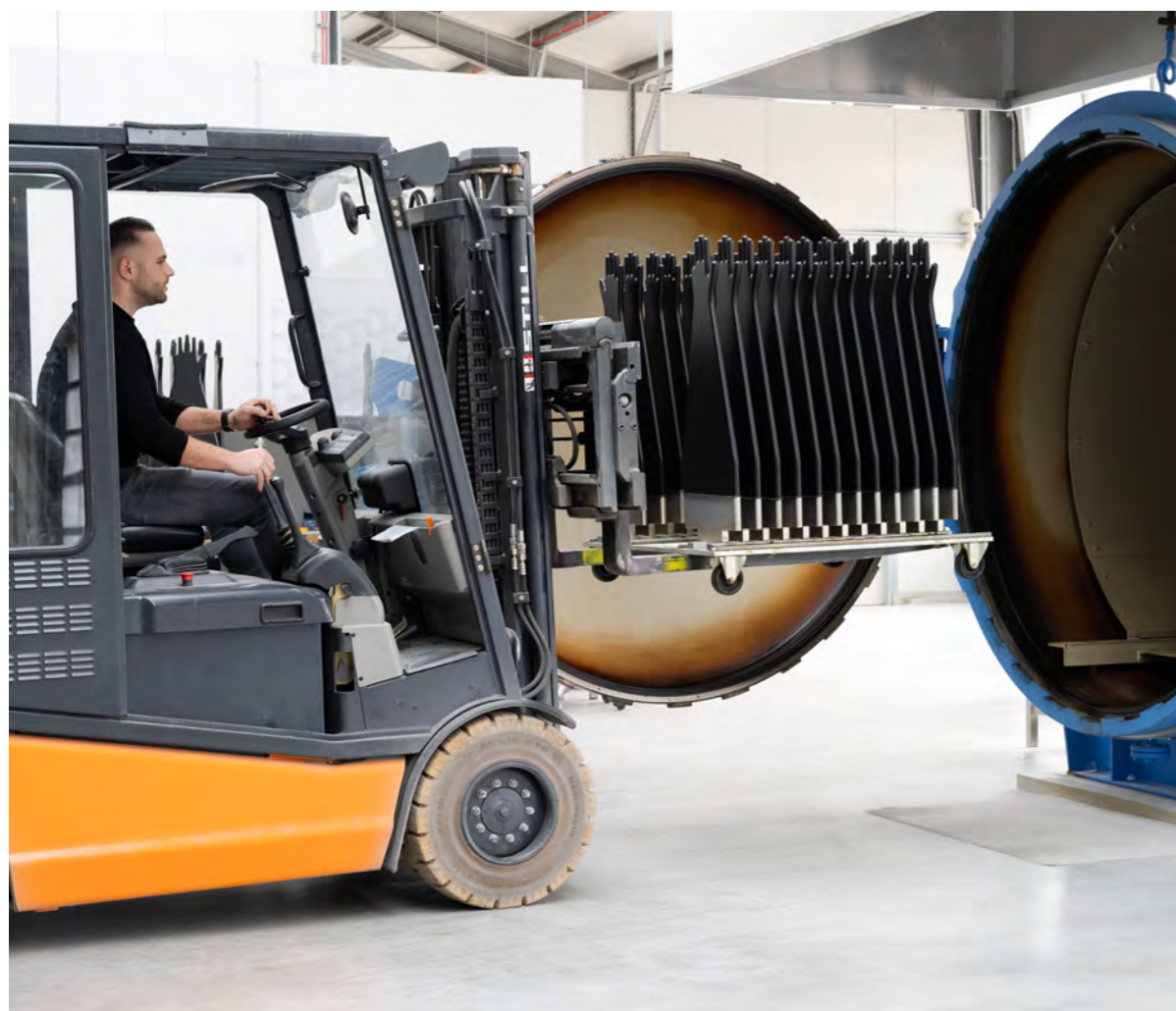
Fertige Gummihandschuhe werden aus dem Autoklaven herausgeholt.
